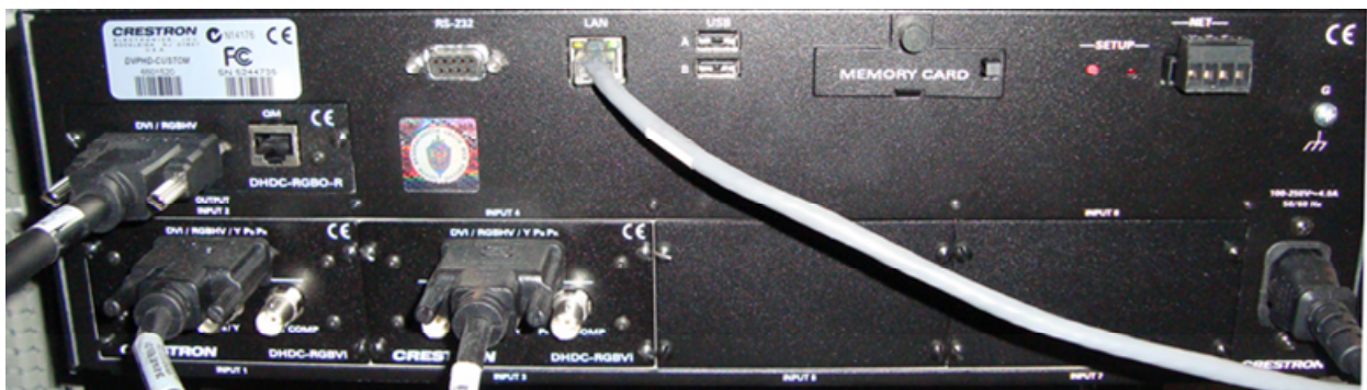
Рис. 2 Задняя панель DVPHD – Custom, интерфейсы.
